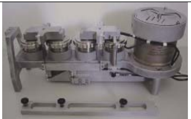
Vue d'un banc expérimental permettant de stimuler mécaniquement en des os artificiels afin de vérifier leur comportement en situation de charge physiologique
