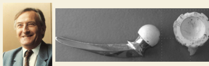
Figure 8. P. Boutin ( https://www.sofcot.fr/sites/www.sofcot.fr/files/medias/documents/3%20Le%20couple%20céramique.pdf ) et Prothèse de Pierre Boutin ongue par CERAVER - tige inox cimentée, couple de frottement en alumine - Ceraver©
