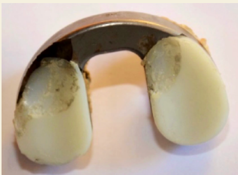
Figure 18. Usure massive d'un plateau tibial à conservation des ligaments croisés
