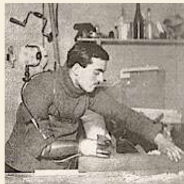
Figure 3 : Varlope dynamométrique La force et la vitesse des mouvements du coude sont enregistrées au cours de l'entraînement.
