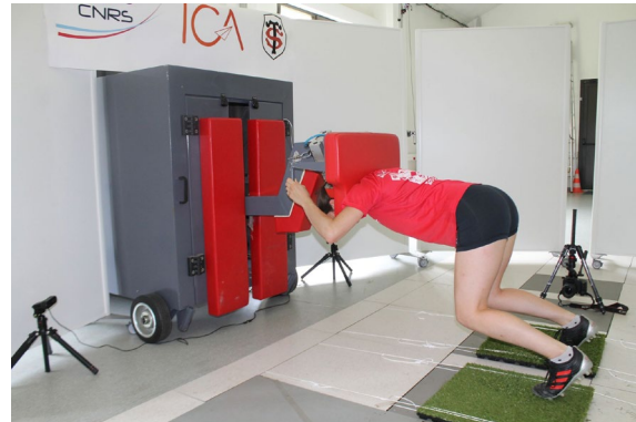
Figure: exemple de semelles instrumentées pour la détermination des forces de poussée au LAAS-CNRS.
