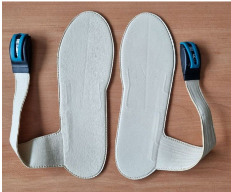
Figure: exemple de semelles instrumentées pour la détermination des forces de poussée au LAAS-CNRS.
