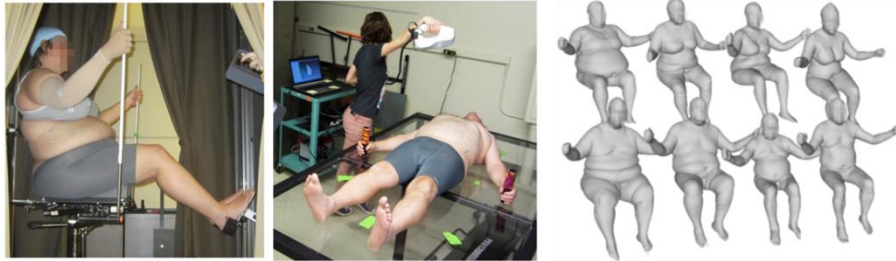
Figure 1 : protocole expérimental pour le scan de surfaces de volontaires en postures assises et couchées (Jones et al., 2016)
